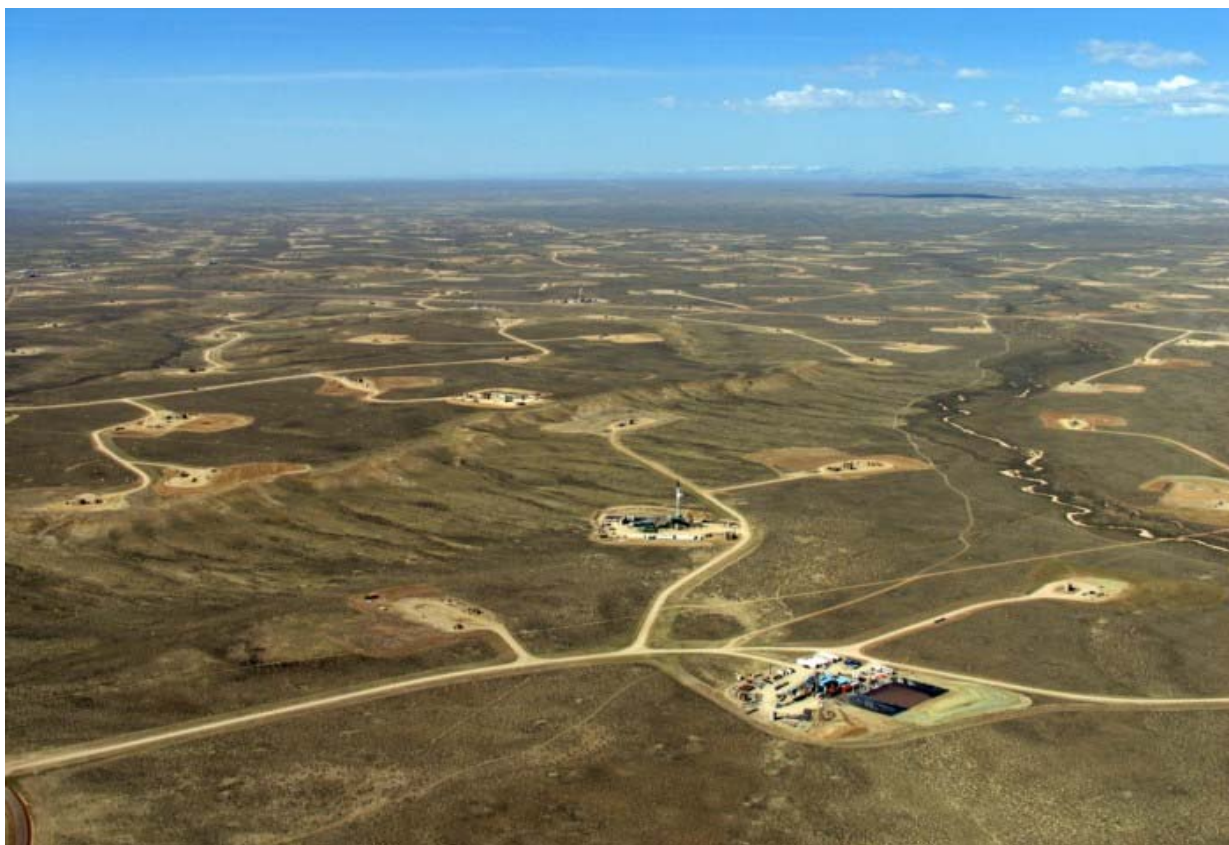
Figura 2: Puțuri de gaz din formațiuni compacte săpate în piatră de nisip
